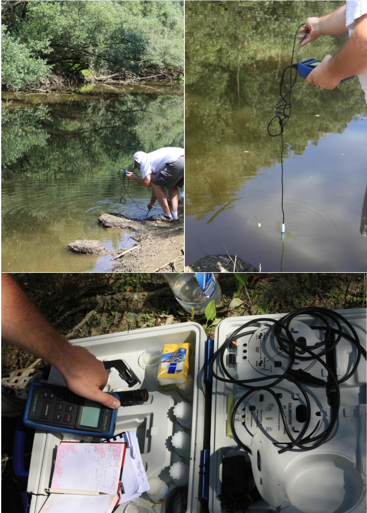
**Slika 4.** Mjerenje osnovnih fizikalno-kemijskih parametara vode pomoću WTW sonde (Foto: D. Jelić)
