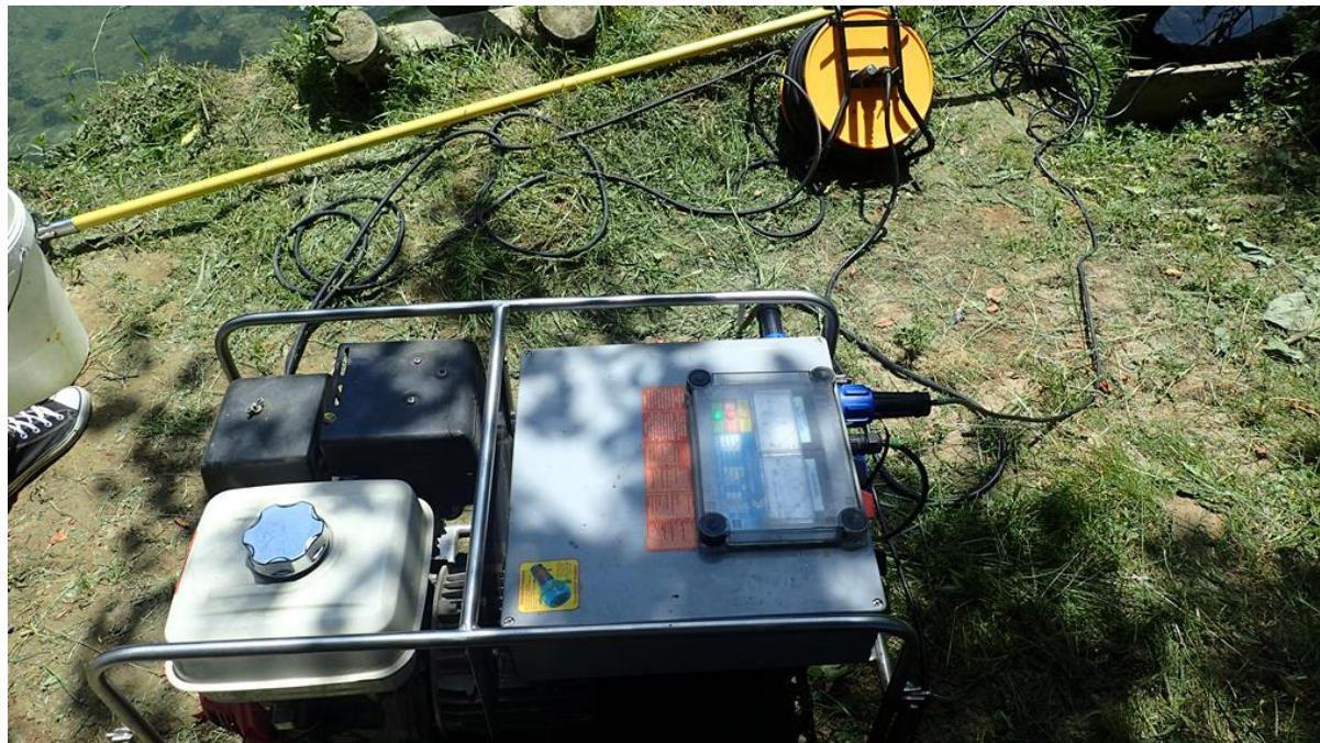
**Slika 4.:** Stacionarni agregat Hans-Grassl EL63 II GI izlazne snage 6,5 kW
