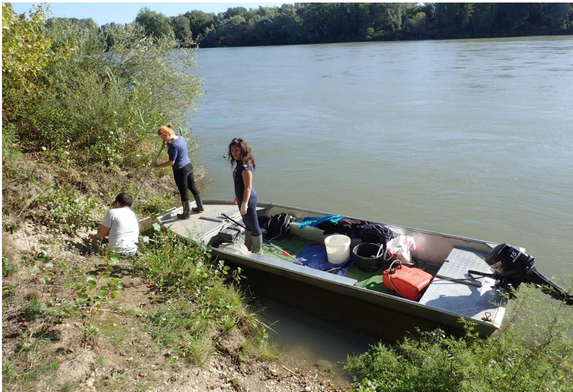
**Slika 5.:** Aluminijski čamac s benzinskim motorom i električnim stacionarnim agregatom za elektroribolov
