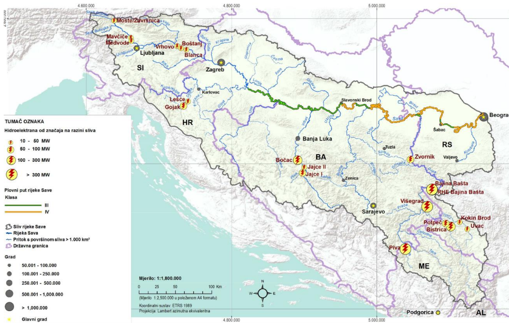
Slika 2.17 Postojeća infrastruktura u slijevu rijeke Save Izvor: Međunarodna komisija za sliv rijeke Save, 2014
